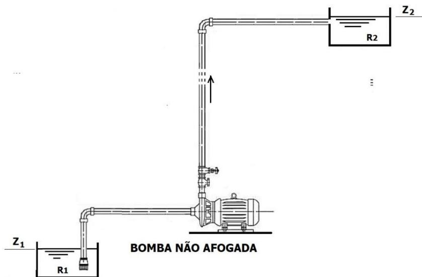
Para os fins do presente texto, com relação ao trecho de sucção, onde o conduto conduz o líquido do reservatório inferior até a bomba, o conjunto elevatório se configura de duas maneiras:
